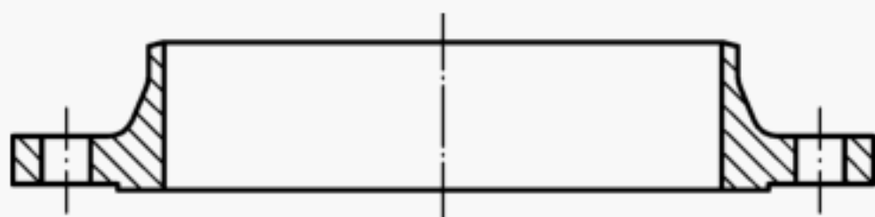
h) Type 11 Weld-neck flange
